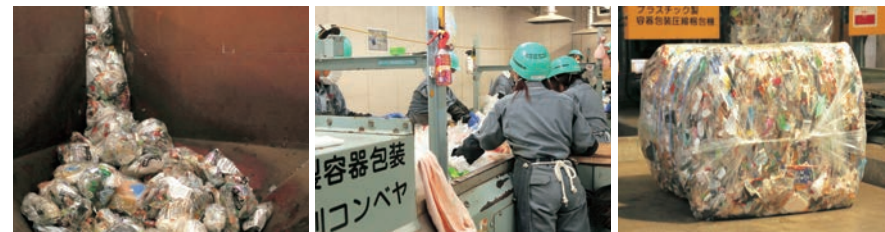
①回収された袋がコンベヤ ②資源としてリサイクルでき ③資源として新たな形へ を使い作業工程へ ない製品を手作業で分別 生まれ変わります
