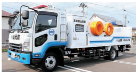
■ポンプ規格 総排水量 毎分30立方分 連続運転時間 48時間
