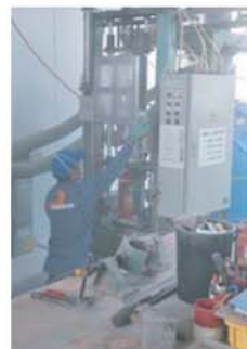
廃消火器内の粉末消火薬剤の抜き取り作業
